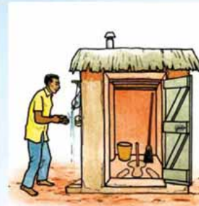
Dans une latrine lavable munie d'un toit, d'une porte et d'un dispositif LMS
