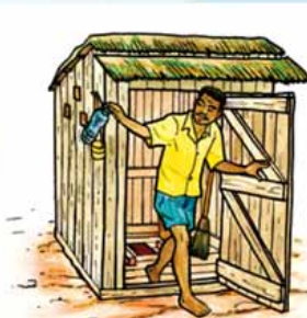
Dans une latrine à dalle artisanale en terre battue ou en bois, munie d'une porte, de murs, d'un toit et d'un dispositif LMS
